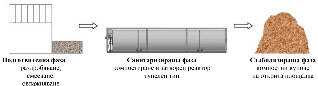
Фиг.3. Принцирна схема на система за компостиране от затворен тип
